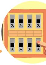
ご使用中の電気器具をコンセントから抜いたうえで、安全ブレーカーのつまみを上げてください。
