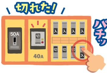
4 漏電ブレーカーが切れたら今入れた安全ブレーカーの回路に漏電があります。
